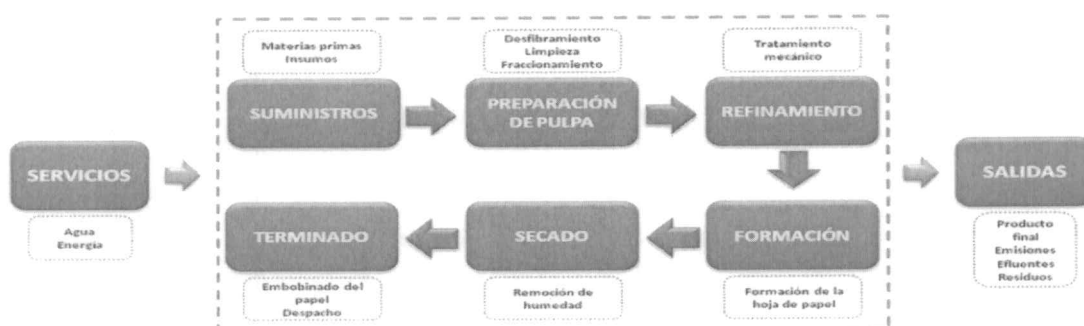
Gráfico 1. Diagrama de flujo de Proceso Molino 5
